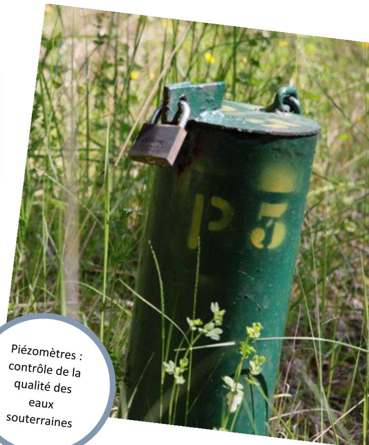
Piezomètres : contrôle de la qualité des eaux souterraines
