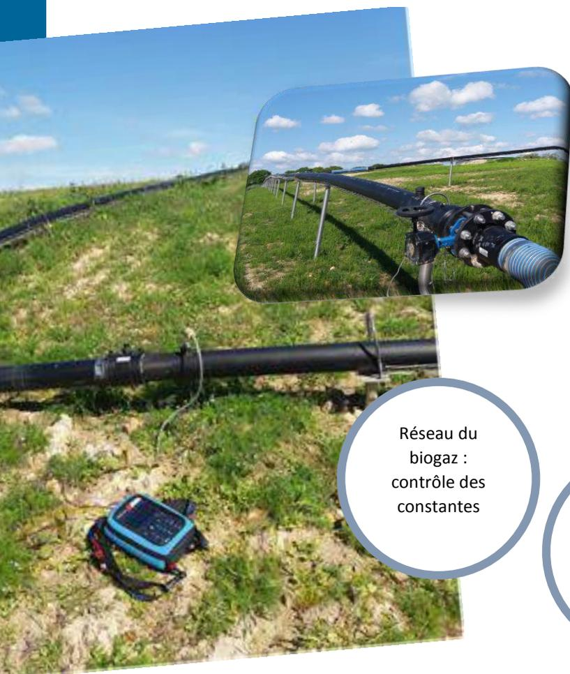
Réseau du biogaz : contrôle des constantes
